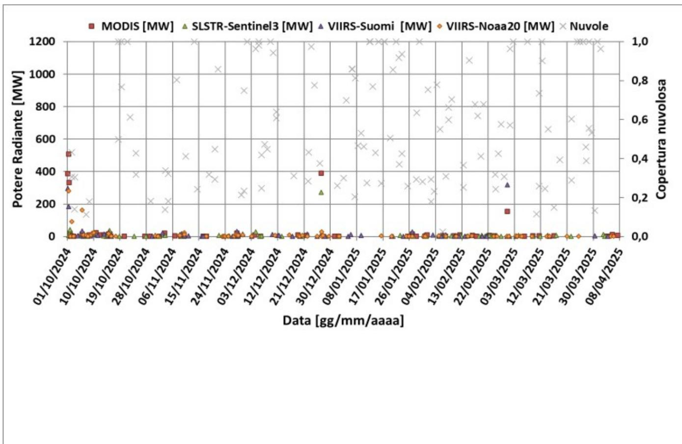
Fig. 7.1 Potere radiante calcolato da dati MODIS (quadrato rosso), SENTINEL-3 SLSTR (triangolo verde) e VIIRS (triangolo viola e rombo giallo) dal 1° ottobre 2024 all'8 aprile 2025.
