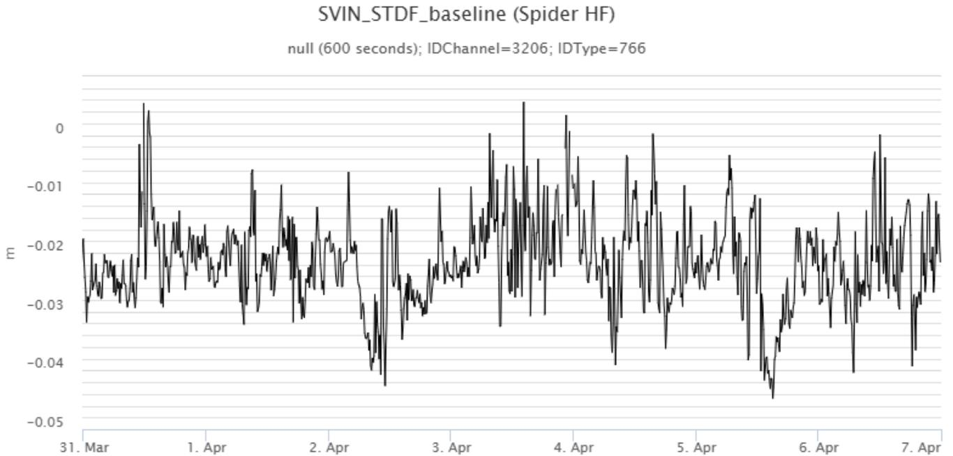
**Fig. 5.1** Serie temporale della variazione di distanza (in m) tra le stazioni GNSS di SVIN e di STDF, nel corso dell'ultima settimana.
