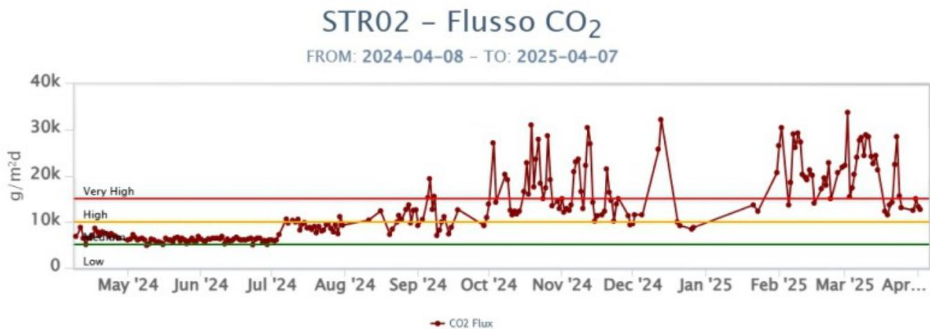
**Fig. 6.2** Andamento del flusso CO<sub>2</sub> misurato sul Pizzo sopra la fossa, negli ultimi tre mesi e nell'ultimo anno.
