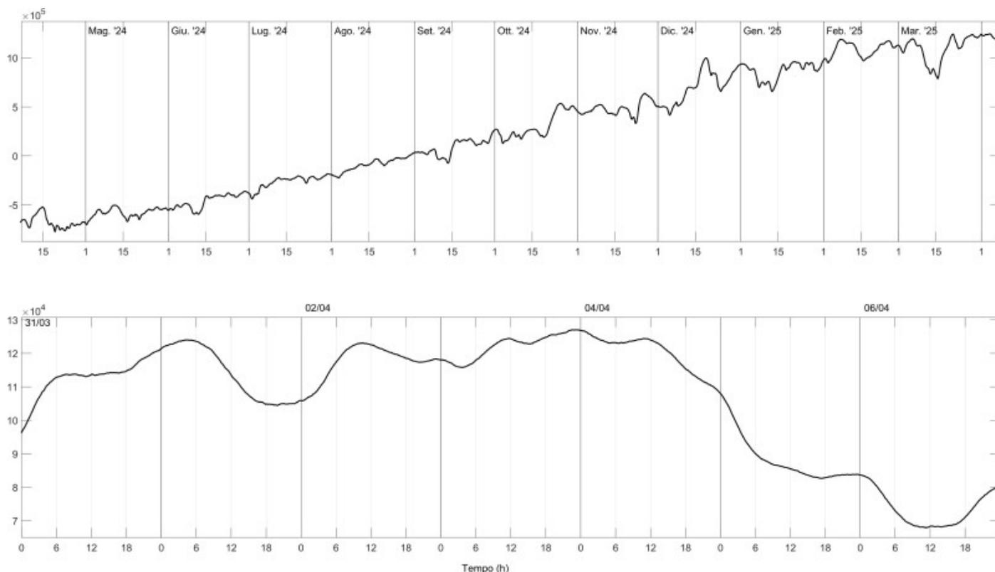
**Fig. 4.3** Grafico relativo al dato dilatometrico registrato a SVO: in alto viene mostrato lo strain registrato nell'ultimo anno dal 07/04/2024; in basso quello registrato nell'ultima settimana.
